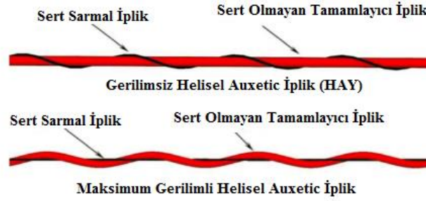
Şekil 9. Helisel auxetic iplik (HAY) yapısı (Sloan vd., 2011:476)
