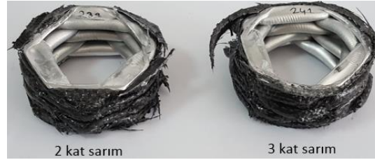
Şekil 13. Farklı sarım sayılarındaki karbon elyaf takviyeli tüplerin deney sonrası görüntüsü
