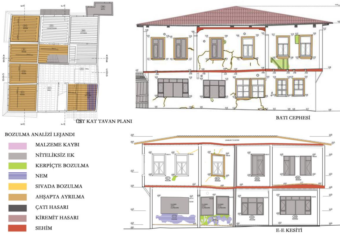
Şekil 32: Remzi Bey Konağı'nın bozulma analizi örnekleri (GTÜ Restorasyon Arşivi, 2017).
