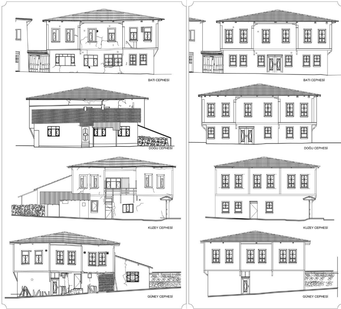
Şekil 21: Remzi Bey Konağı cephe rölöveleri ve restitüsyonları (GTÜ Restorasyon Arşivi, 2016).
