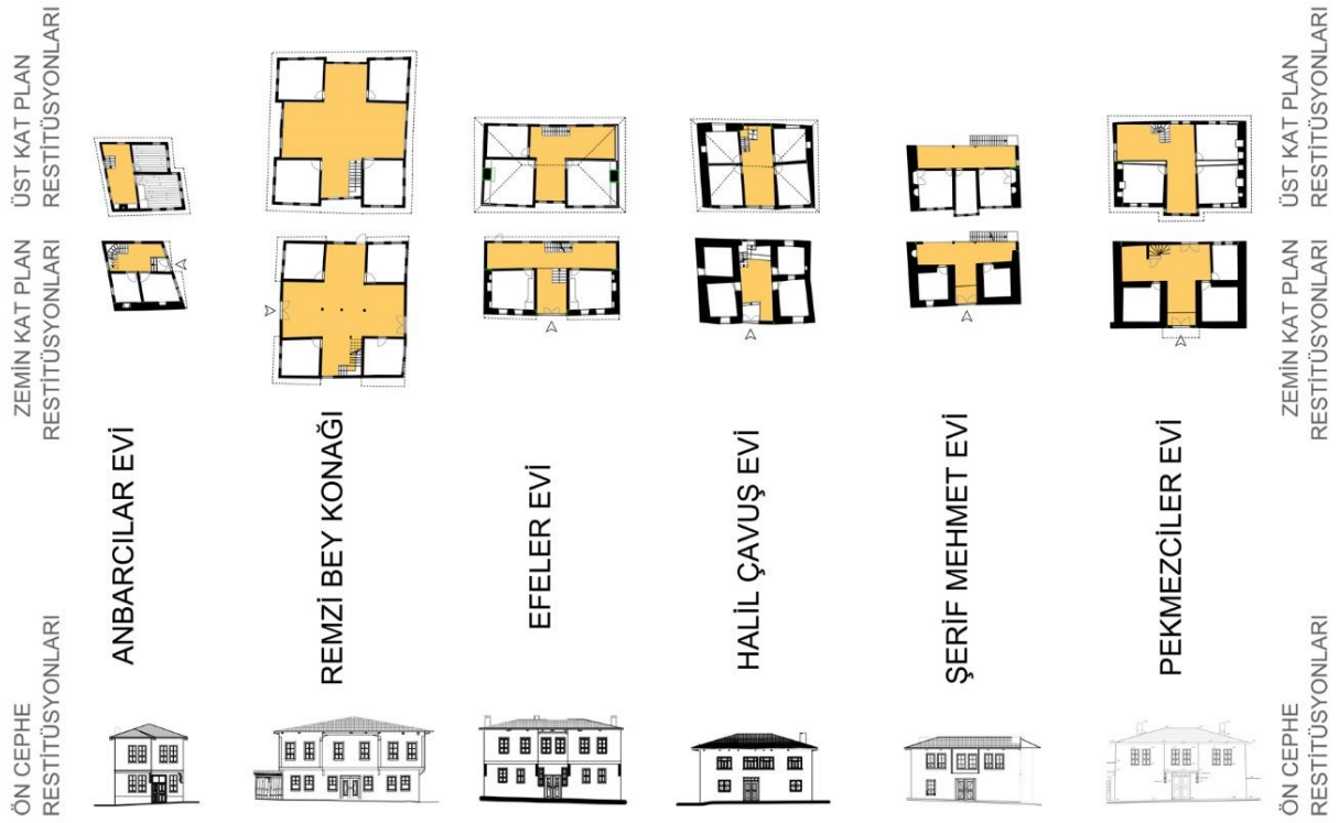
Şekil 25: Orhaneli geleneksel yapıları plan ve cephe restitüsyon örnekleri (GTÜ Restorasyon Arşivi, 2016-2018).
