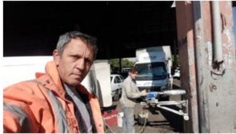
Şekil 6. Taşıyıcı betonarme kolonlarda gerçekleştirilen karot/basıncı deneyi çalışması
