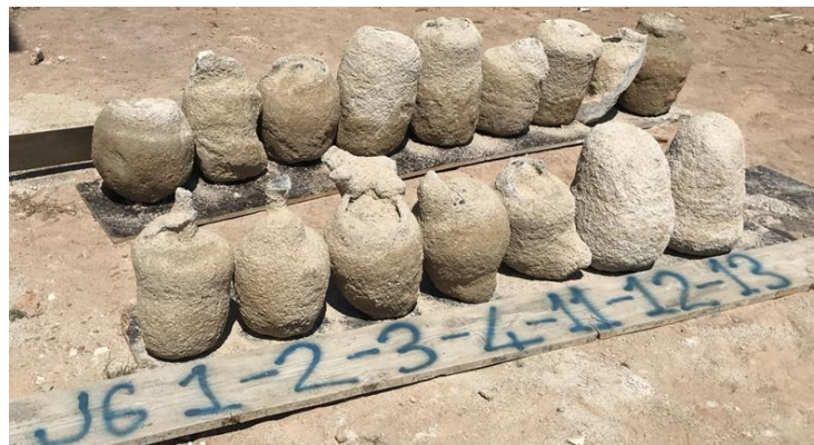
Şekil 2. Jet grout kolonlarının görünümü.
