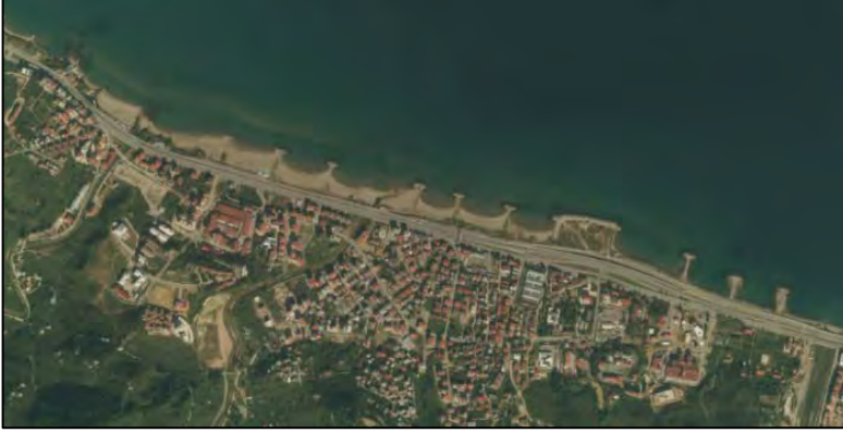
Fotoğraf 4. Giresun batısında kıyı mahmuzları. Dalgaların kıyıdaki tahribatını önlemek üzere yapılan bu yapıların araları, denizden gelen kumla dolmuştur (Google Earth'den alınmıştır).
