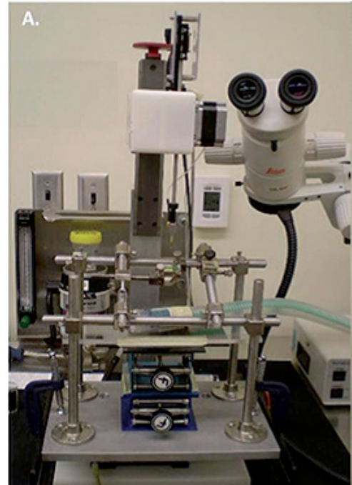
Şekil 6. Infinite Horizon çarpma tertibatı (Lee H.T ve ark. alınmıştır)
