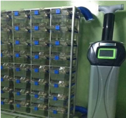
Resim 1. Bireysel havalandırma kafesi
