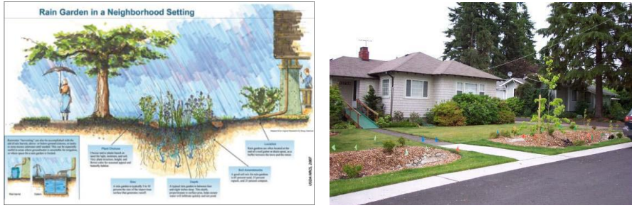
Şekil 3. Yerleşme alanlarında tipik bir yağmur bahçesi düzenlemesi örneği (Donaldson, 2009)
