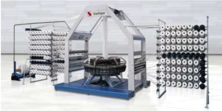
Şekil 21. Dairesel leno dokuma makinesi (Starlinger 2016)
