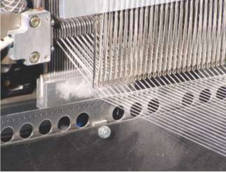
Şekil 16. Vuts CAMEL dokuma makinesi çözgü iplik geçişleri (Vuts 2016)
