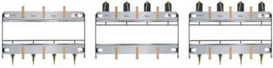
Şekil 8. PosiLeno pozitif leno sistemi çerçeveleri (Grozbeckert 2016)
