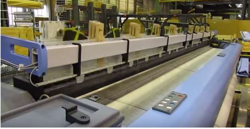
Şekil 5. Çerçeveli leno sistemleriyle çalışan dokuma makinesi (Grozbeckert 2016)
